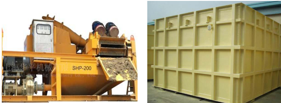
图 6.2-3 泥浆净化装置和钢制泥浆池
